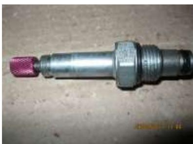
Пневматический клапан спуска для станций PU-E1 и PU-E2
