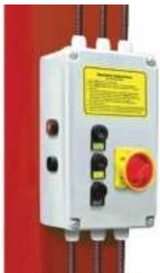
Пульт управления для четырехстоечного подъемника.
