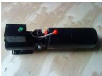
PU-M1/380 Гидростанция от подъемника до 5тн
