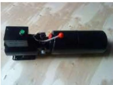
Гидростанция от подъемника РЕАК 220V электрическая.
