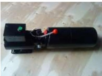
Гидростанция от подъемника РЕАК 220V электрическая.
