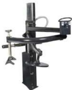
Многофункциональное приспособление, которое предназначено для монтажа/демонтажа низко профильных, широких и жестких шин. Данная установка значительно ускоряет процесс бортировки
