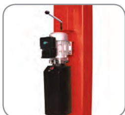
Механическое управление стопорами на одной колонне
