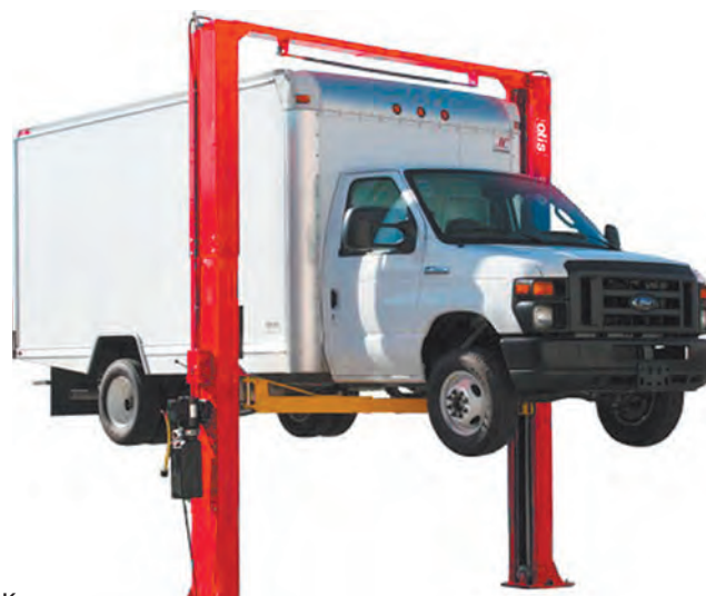
Механическое управление стопорами на одной колонне
