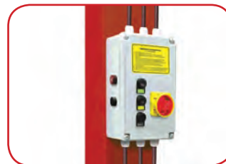
Пульт управления всеми операциями, пневматическое управление стопорами
